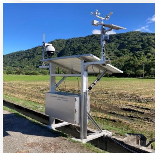
LoRa NB-IoT 通訊結合太陽能供電系統之微型氣象站及高解析度影像自動資料收集攝影機
