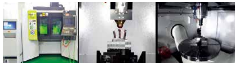
（左）五軸加減法複合工具機、（中）金屬積層製造（DED）、（右）五軸切削加工
